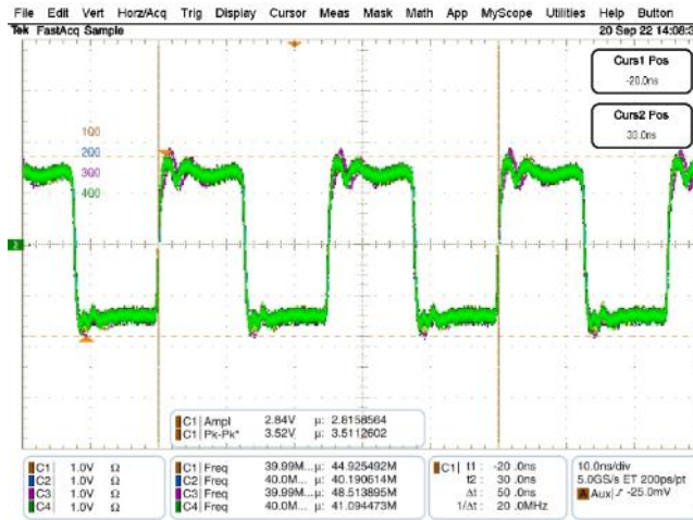
Figure 20a: O'scope waveforms: RadClock™ Output Signals: 1Q0, 2Q0, 3Q0, 4Q0
