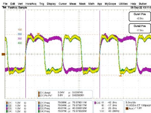
Figure 10a: O'scope waveforms: RadClock™ Output Signals: 1Q0, 2Q0, 3Q0, 4Q0
