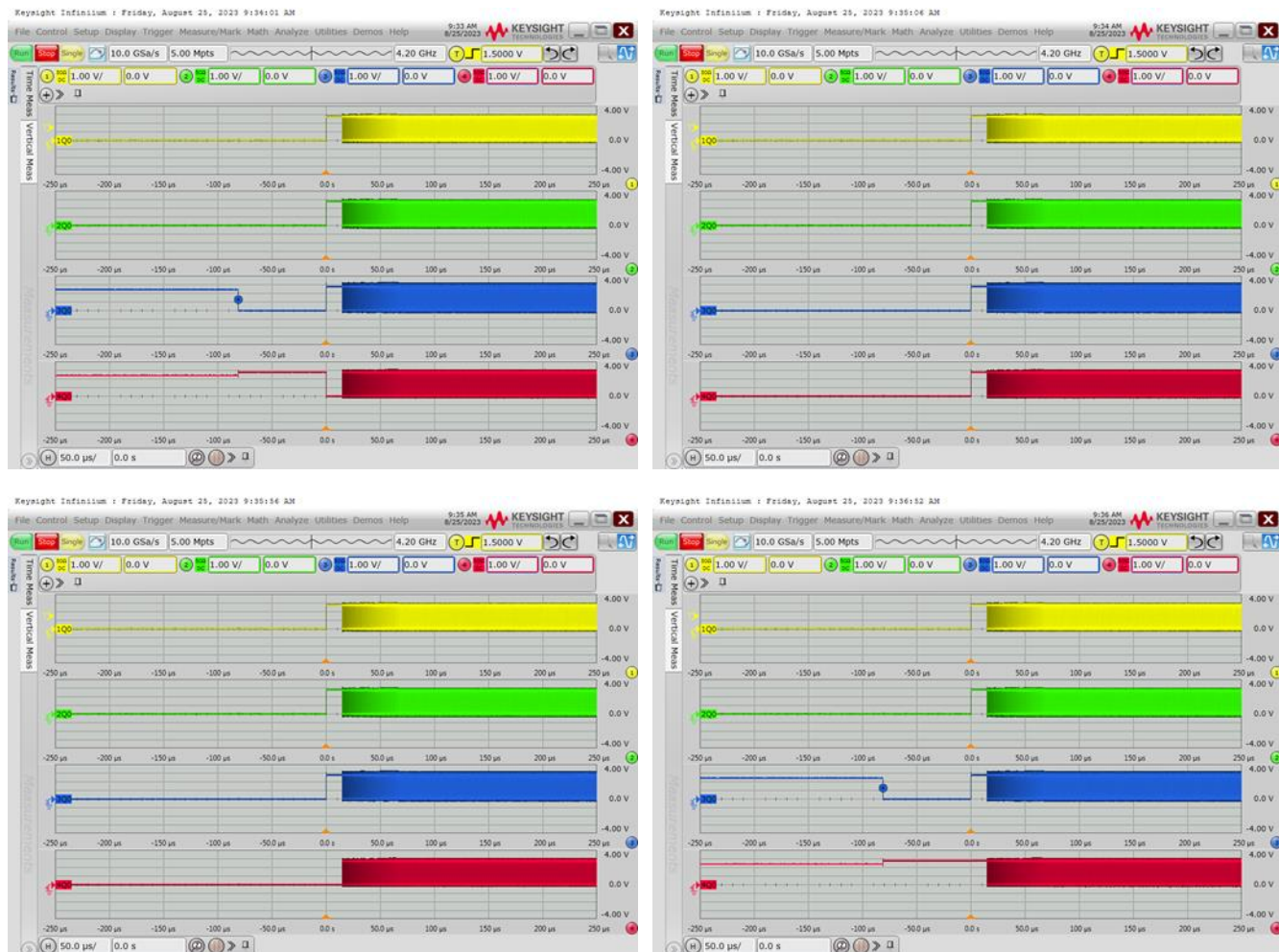
Figure 3a2: O'scope waveforms: RadClock™ Output Signals: 1Q0, 2Q0, 3Q0, 4Q0
